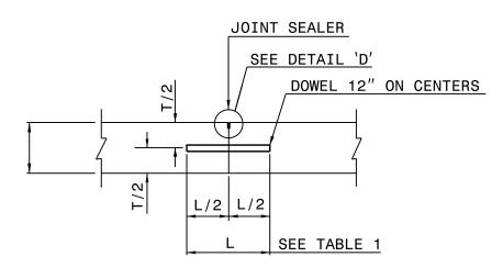
PLANNED TRANSVERSE CONSTRUCTION JOINT
