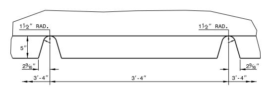
PART ELEVATION OF LIFT SLOT
