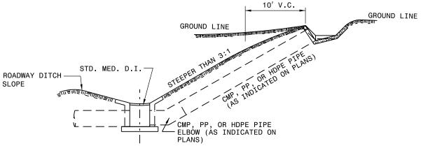
**ELEVATION FOR SLOPE GREATER THAN 3:1**
