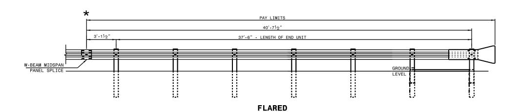
\*WHEN INSTALLING GUARDRAIL END UNITS THAT ARE 31" MOUNTING HEIGHT TO EXISTING GUARDRAIL, REMOVE THE EXISTING GUARDRAIL TO TRANSITION FROM THE EXISTING HEIGHT TO THE PROPOSED 31" HEIGHT. SEE 862.02, SHEET 4 OF 8 FOR TRANSITION DETAILS.
