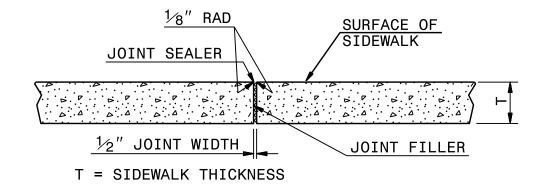
TRANSVERSE EXPANSION JOINT IN SIDEWALK
