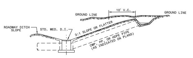
**ELEVATION FOR SLOPE 3:1 OR LESS**
