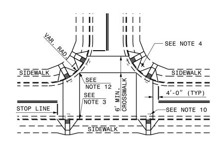
DETAIL SHOWING TYPICAL LOCATION OF CURB RAMPS,
