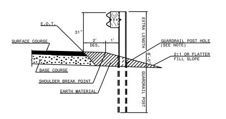
8' GUARDRAIL POST ON 2:1 SLOPE \*
