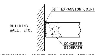
EXPANSION JOINT FOR RIGID STRUCTURE
