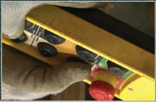
La inspección de los controles de levantamiento y los frenos
