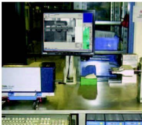
Messaufbau zur Charakterisierung der Sonotroden
